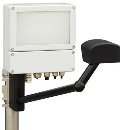
Прибор состоит из источника света и стереокамеры. Частицы проходят через измерительный объем, определяемый углами обзора камер, а также минимальным и максимальным расстоянием от камер.
