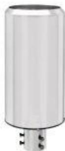
Измеряющий ресивер передает измеренные значения количества осадков и их интенсивность. В зависимости от максимально возможной интенсивности, датчик подсчитывает или количество капель, или количество опрокидываний емкости для сбора капель, или оба этих процесса вместе. Воронка для сбора воды оцинкована, а крышка сделана из шлифованной нержавеющей стали. Нагревательная система снабжена термостатом.
