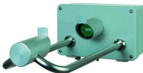
Служит в качестве измеряющего датчика и хорошо подходит для измерения и определения различных типов осадков, таких как: Морось, дождь, град, снег, смешанные осадки. Прибор различает любые типы осадков, интенсивность и спектр. Все измеренные значения доступны для пользователя через интерфейс RS485/422. Кроме того, прибор оборудован двумя цифровыми выходами (опто-волокно). Оптические компоненты оборудованы встроенным обогревом.
