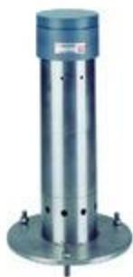
Служит для автоматических измерений высоты испарения с помощью ультразвукового сенсора. Датчик замеряет уровень воды на контрольной высоте, затем, по мере понижения уровня воды, замеры проводятся непрерывно. Датчик имеет выход для последовательно передаваемых телеграмм. Имеется возможность для соединения напрямую с THIES-Datalogger TDL14 / DLxMET / DL16, например. Данный датчик является термокомпенсированным.
