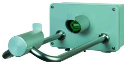
Служит в качестве измеряющего датчика и хорошо подходит для измерения и определения различных типов осадков, таких как: Морось, дождь, град, снег, смешанные осадки. Прибор различает любые типы осадков, интенсивность и спектр. Все измеренные значения доступны для пользователя через интерфейс RS485/422. Кроме того, прибор оборудован двумя цифровыми выходами (опто-волокно). Оптические компоненты оборудованы встроенным обогревом.
