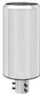
Датчик осадков работает в импульсном режиме. Датчик служит в качестве сенсора для определения количества и интенсивности осадков в цифровом формате. Измерительные принципы соответствуют «Руководству по метеорологическим приборам № 8» ВМО. Осадки попадают в опрокидывающийся сосуд через площадь водосбора и канал. По достижении максимального значения осадков сосуд опрокидывается.
