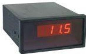
Цифровой индикатор скорости ветра S двумя регулируемыми предельными контактами. Плоский индикатор для отображения значений скорости ветра. Две установочные кнопки на передней панели предназначены для установки двух беспотенциальных контактов реле. Светодиодные цифры отображают переключение функций. Для облегчения чтения красных цифр фон индикатора черный.
