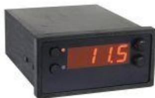
Цифровой индикатор для панельной установки. Индикатор с плоским сечением для отображения значений влажности, температуры или давления. Две установочные кнопки на передней панели служат для установки беспотенциальных контактов реле. Фон индикатора - черный для облегчения чтения красных цифр. Предпочтительна установка на панели переключателей или на передней панели.
