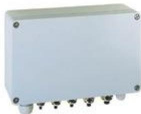
Используется для электропитания датчиков скорости и направления ветра или комбинированных приборов. Имеется встроенная защита от перенапряжения (варисторы) и клеммная колодка для соединения и распределения кабелей. Подходит для: Серия датчиков скорости ветра: • Somrast • Classic • First Class • Ультразвуковой 2 D, 1D Преобразователь параметров: • Clima датчик
